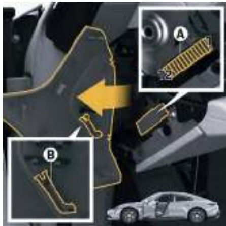
Fig. 68: Left fuse box
